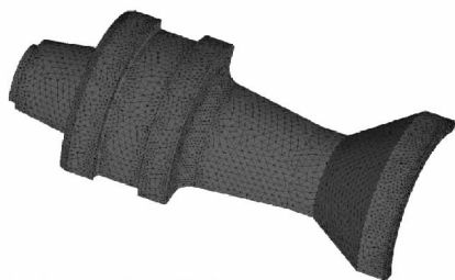
(b) 卡瓣表面网格细节图 (b) Detailed surface mesh of sabot
